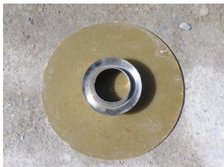
Stanovení míry rozlití pomocí Hägermannova trychtýře a podložky.
